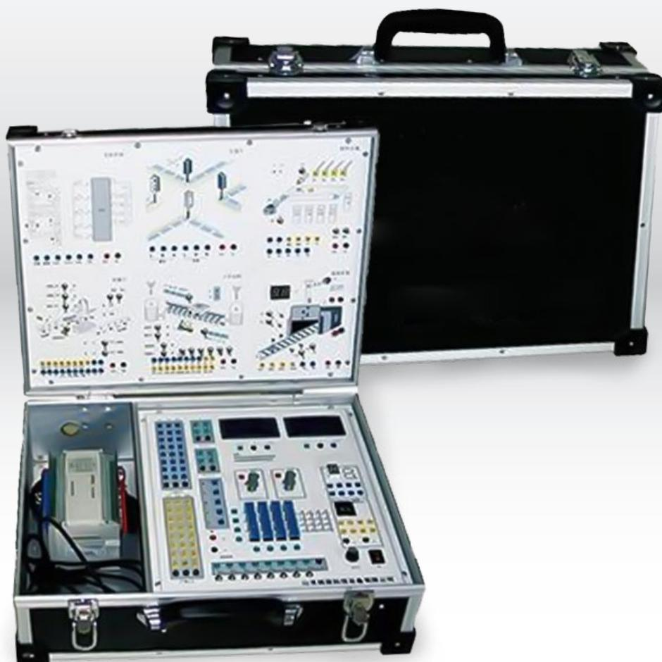
Il Laboratorio portatile integra sei moduli di addestramento PLC tipici, tra cui controllo del motore, controllo del livello dell'acqua della torre dell'acqua, laminatoio automatico, miscelazione di liquidi multipli, smistamento della posta e alimentazione e caricamento automatici. È facile completare la formazione di base del PLC e l'alimentatore del carico hardware utilizza una tensione sicura per garantire la sicurezza degli studenti.
